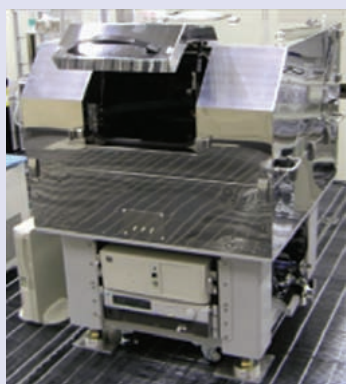
図7 開発したナノプリント装置 「ケミカル・ナノインプリンター」
