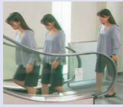
止まったエスカレーターに乗り込むと姿勢が崩れ、違和感を感じるが、手すりと移動床面をカバーで隠すとそれらがなくなる。
