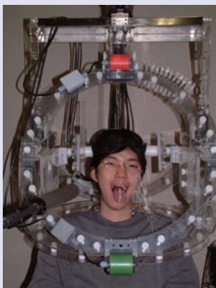
(a) 磁気センサシステム
