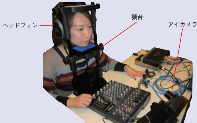
ヘッドフォンから音楽を聴取しているときの眼球運動と瞳孔径変化を、正面下方に設置されたアイカメラで計測する
