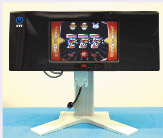
3D表示エリア：対角8インチ，奥行き5mm
