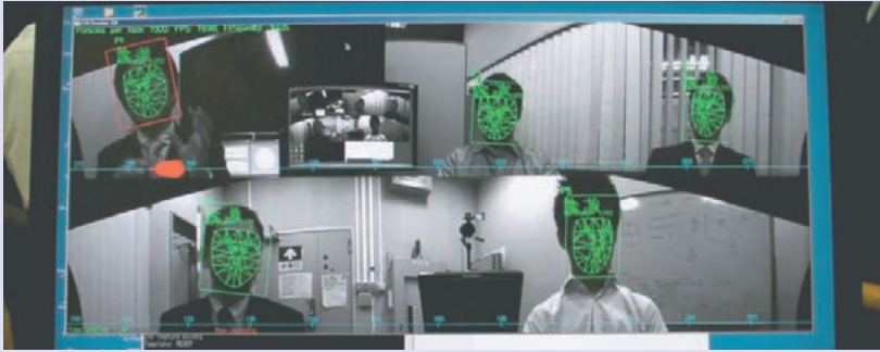
図4 顔の位置・方向の推定の結果, および音声区間検出の結果
