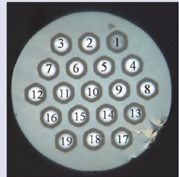
作製した光ファイバの断面 6モード×19コア=114チャンネル
