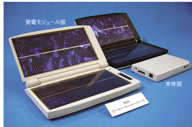
太陽電池入力型携帯電源（試作機）
